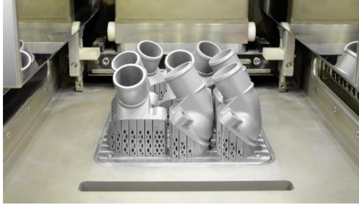
Şekil 8. 3 Boyutlu Yazıcı ile Metal Parça Üretimi (Kaynak: https://www.tridi.co )
