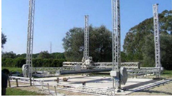
Şekil 5. D-Shape 3D Yazıcı (Kaynak: https://3dprintingindustry.com )
