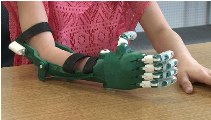
Şekil 2. 3 Boyutlu Yazıcı Teknolojisi İle Üretilmiş Protez Kol
